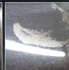
Korozja po ptasich odchodach
